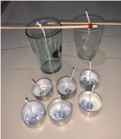
Gambar 10. Penyangga sumbu sudah terpasang
