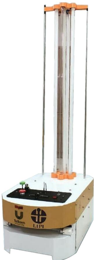
Autonomous Ultraviolet C (UVC) Mobile Robot bertugas melakukan desinfeksi dan sterilisasi pada ruang isolasi pasien positif COVID-19 tanpa campur tangan manusia secara langsung.
