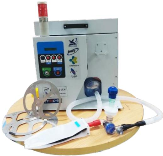
*Emergency Ventilator* merupakan alat bantu pernapasan ringan untuk situasi gawat darurat pada saat pasien berada di ambulans dan IGD sebelum mendapat pertolongan ventilator ICU. Ventilator ringan ini menggunakan *bag valve mask (BVM) ventilation* yang juga dikenal sebagai ambu bag.
