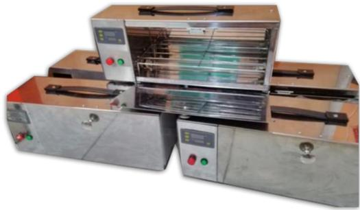
Box sterilisasi ini merupakan alat untuk mensterilkan masker N-95 yang wajib digunakan tenaga kesehatan yang berhadapan dengan pasien positif COVID-19 maupun Pasien Dalam Pengawasan (PDP). Box ini menggunakan sinar ultraviolet tipe C (UV-C) dengan kendali intensitas cahaya.
