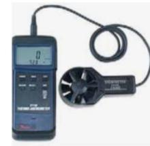
Hasil Ukur velocity anemometer = 2,00 m/s dengan penampang blower fan (30 Cm x 30 Cm)
